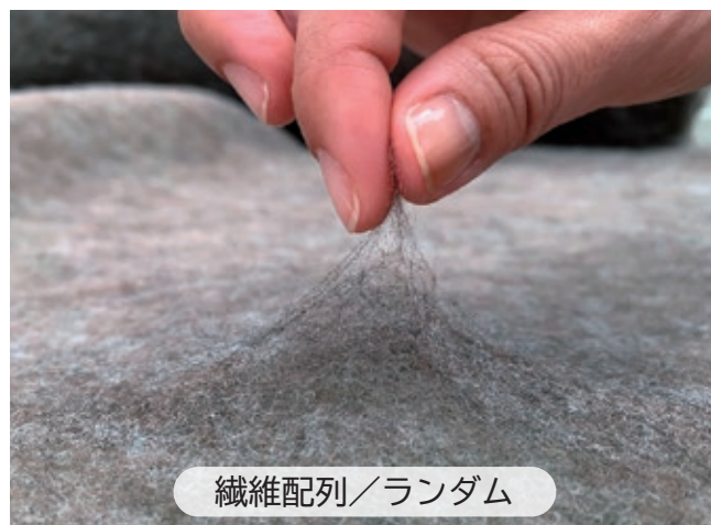
ウェブ (高空隙捲縮性ポリエステル製不織布)
